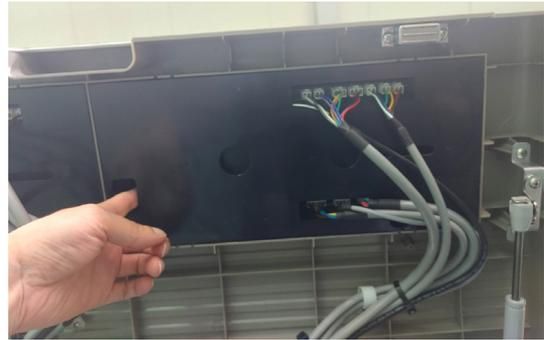
3. LCD 조작 PCB 뒷면에 있는 RESET 버튼을 누릅니다.
